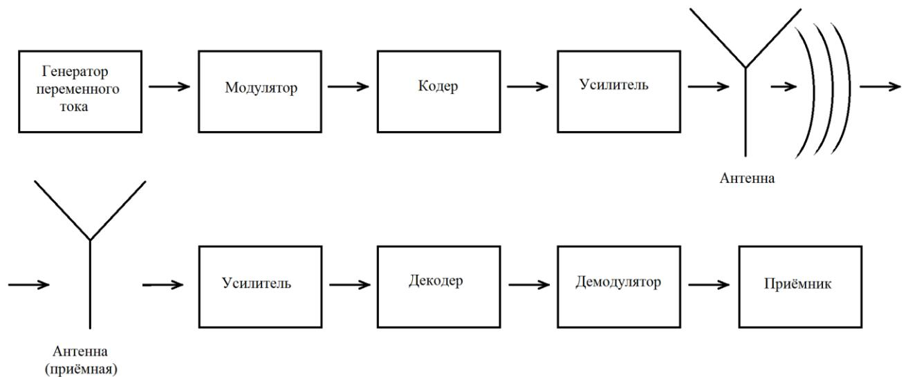
Сигнал от высокочастотного генератора модулируется (меняется по информации) и после усиления излучается антенной. От приемной антенны после демодуляции (выделения полезной информации) сигнал поступает приемнику. Такую возможность передачи сигнала впервые показали Герц (1880 г.), позже Попов и другие.
